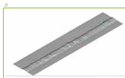
Рис.3. Цифровые реплики поверхности сварного шва Г (311)
